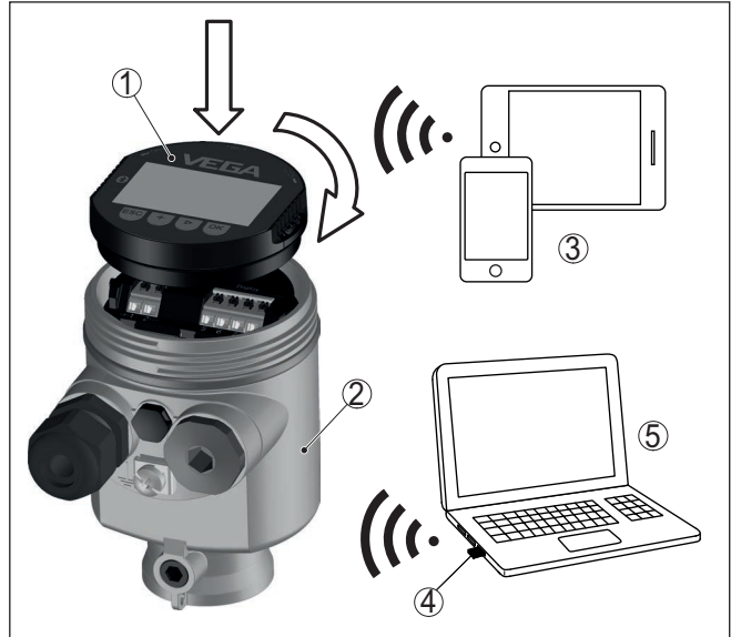
Fig. 2: Draadloze verbinding met standaard verbindingen
